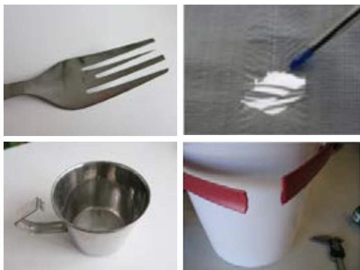
Exemples d'articles non-conformes identifiés lors des Contrôles de Qualité : défaut critique sur une fourchette, trou sur une bâche, poignée cassée sur un seau et sur une tasse.
